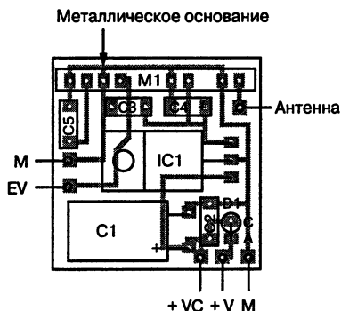
Рис. 5.4. Размещение компонентов миниатюрного видеопередатчика
