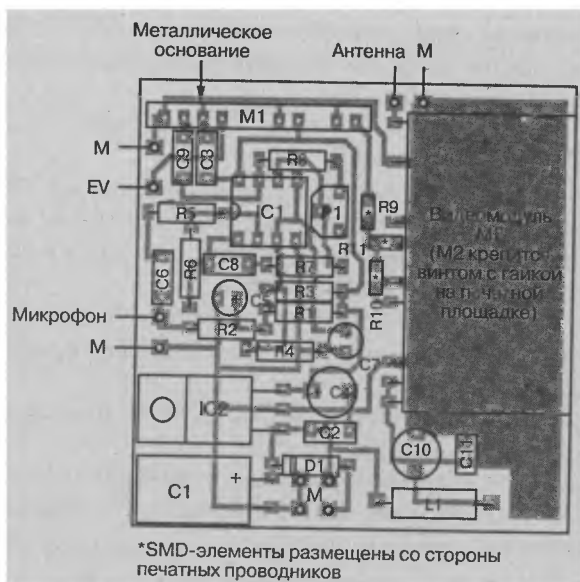
Рис. 5.15. Размещение компонентов видео- и аудиопередатчика большой мощности
