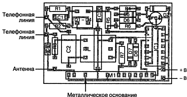
Рис. 3.9. Размещение компонентов автоматического телефонного микропередатчика с частотной модуляцией
